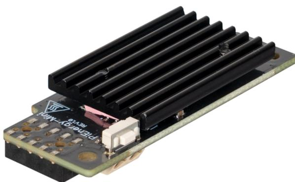
Com o PiEnergy-Mini, pode operar o seu Raspberry Pi com uma tensão de 6 a 36 V DC. Pode utilizar o botão integrado na placa para ligar e desligar o seu Raspberry Pi. A comunicação com o Raspberry Pi é efectuada através do GPIO4, mas esta ligação também pode ser cortada removendo uma resistência para utilizar o pino livremente. Graças ao seu design ultra-plano, também pode ser utilizado em muitas caixas. O conector de pinos está incluído e não é soldado para manter o design ainda mais plano.
