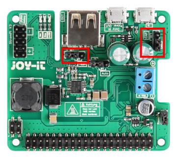
Versorgen Sie nun beide Geräte über den micro-USB-Anschluss (bzw. USB -C) mit Strom.
