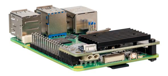
O microcontrolador instalado na placa lê o estado do botão. Se o botão for mantido premido durante um segundo durante o funcionamento do, o GPIO4 do Raspberry Pi é puxado para baixo e 10 segundos depois o conversor de tensão é desligado.
