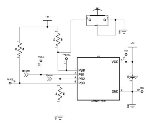
SHTDWN é a ligação ao GPIO4 do Raspberry Pi. Enable é a ligação ao pino de ativação do conversor de tensão na placa.
