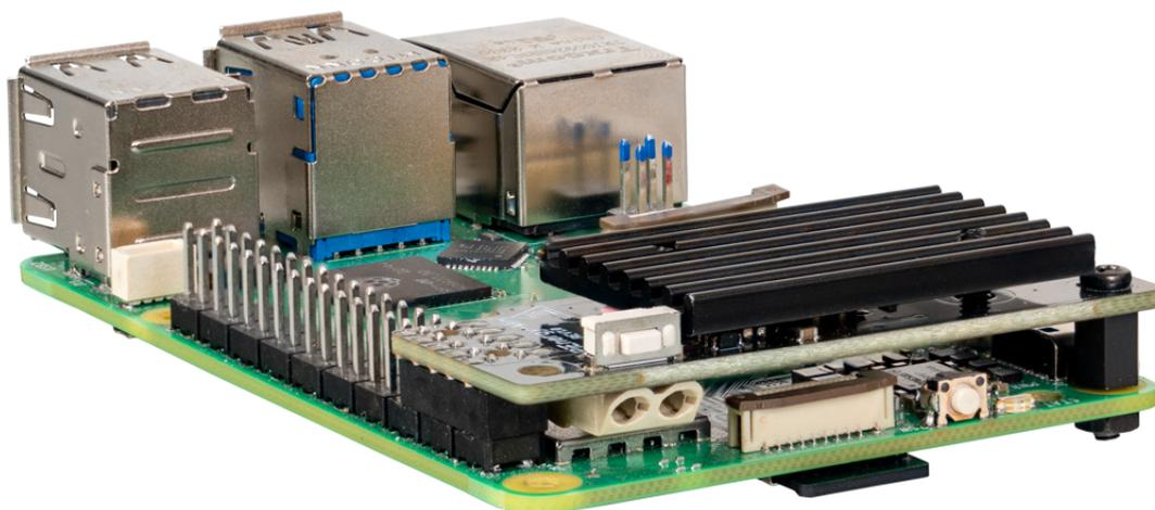
Il microcontrollore installato sulla scheda legge lo stato del pulsante. Se il pulsante viene tenuto premuto per un secondo durante il funzionamento, il GPIO4 del Raspberry Pi viene tirato basso e 10 secondi dopo il convertitore di tensione viene spento.
