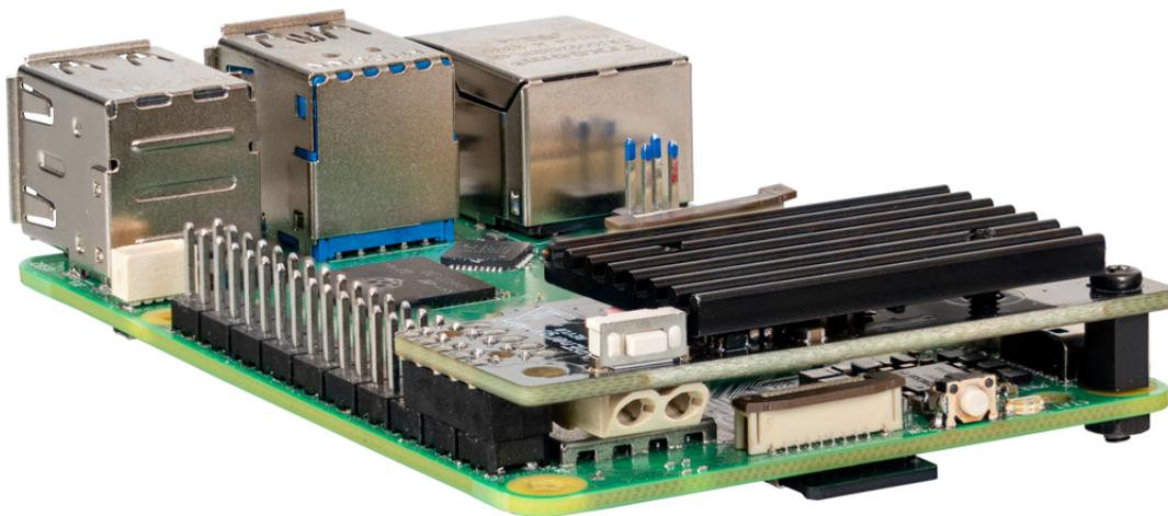
Le microcontrôleur installé sur la carte lit l'état du bouton. Si le bouton est maintenu enfoncé pendant une seconde pendant le fonctionnement de, le GPIO4 du Raspberry Pi est abaissé et 10 secondes plus tard, le convertisseur de tension est éteint.
