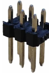
Por ejemplo, un cabezal de 2 x 3 patillas de 2,54 mm es adecuado para este fin.
