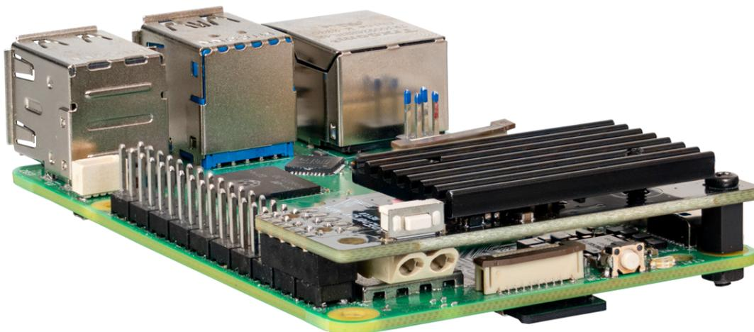
El microcontrolador instalado en la placa lee el estado del botón. Si el botón se mantiene pulsado durante un segundo durante el funcionamiento de, el GPIO4 de la Raspberry Pi se pone a nivel bajo y 10 segundos después se desconecta el convertidor de tensión.
